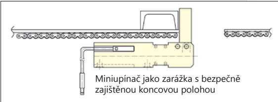
Pneumatiký upínač PKS 25 jako zarážka konstrukčních dílců ve svářecím zařízení – výroba přístrojů pro domácnost
