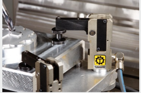
PKSG 20 v závitové verzi na upnutí hliníkového dílce po dobu procesu dělení
