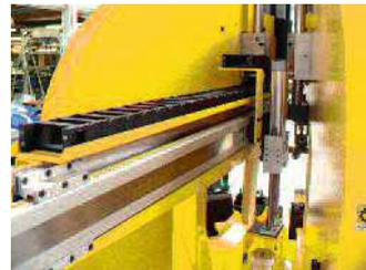
Lineareinheit zum Positionieren von Teilen in der Vorrichtung
