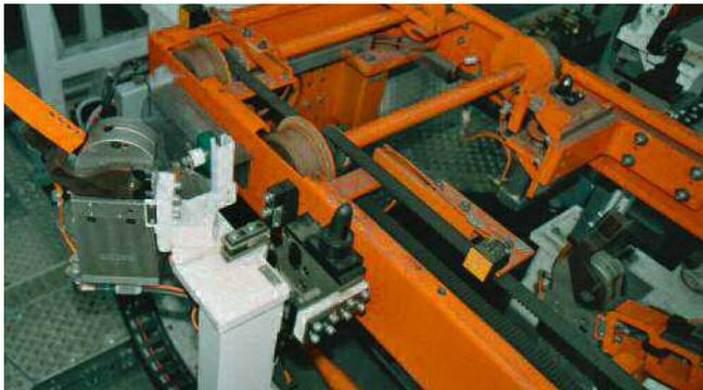
Unterbauspanner zur Aufnahme des Bodens nach Absenken von Rollenbahn
