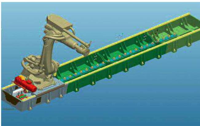
*7te Achse für den Roboter*
