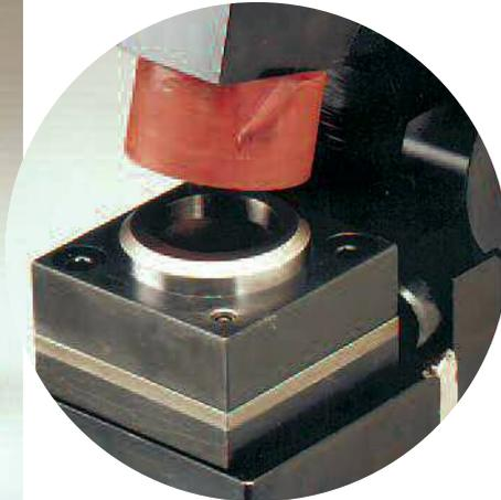
*C-Bügel vorbereitet für eine Butzenabsaugung zum Überkopfstanzen von Löchern*
