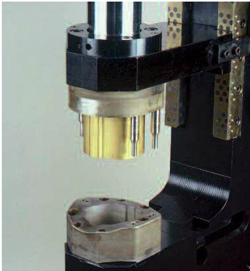
*Bei extremen Hüben und dem Einsatz von Mehrfachwerkzeugen empfiehlt sich zusätzlich eine externe Führung und Verdrehsicherung.*
