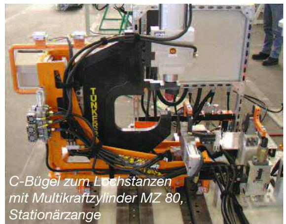
*C-Bügel zum Lochstanzen mit Multikraftzylinder MZ 80, Stationärzange*
