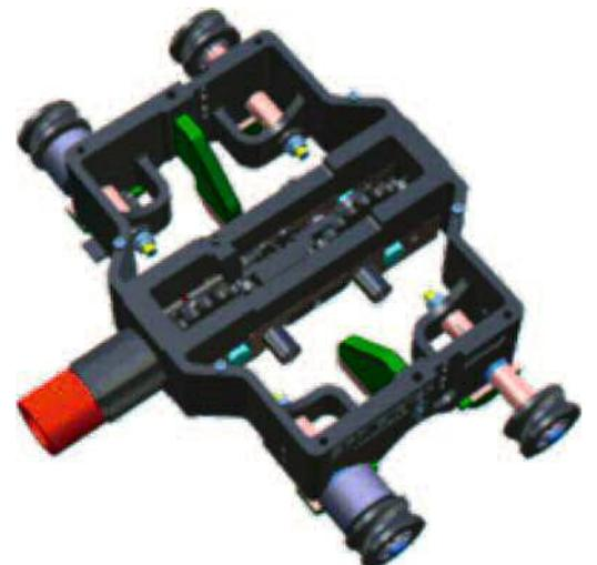
Stauförderband, bei dem die üblicherweise druckluftbetriebenen Elemente durch elektrische Antriebe ersetzt sind.
