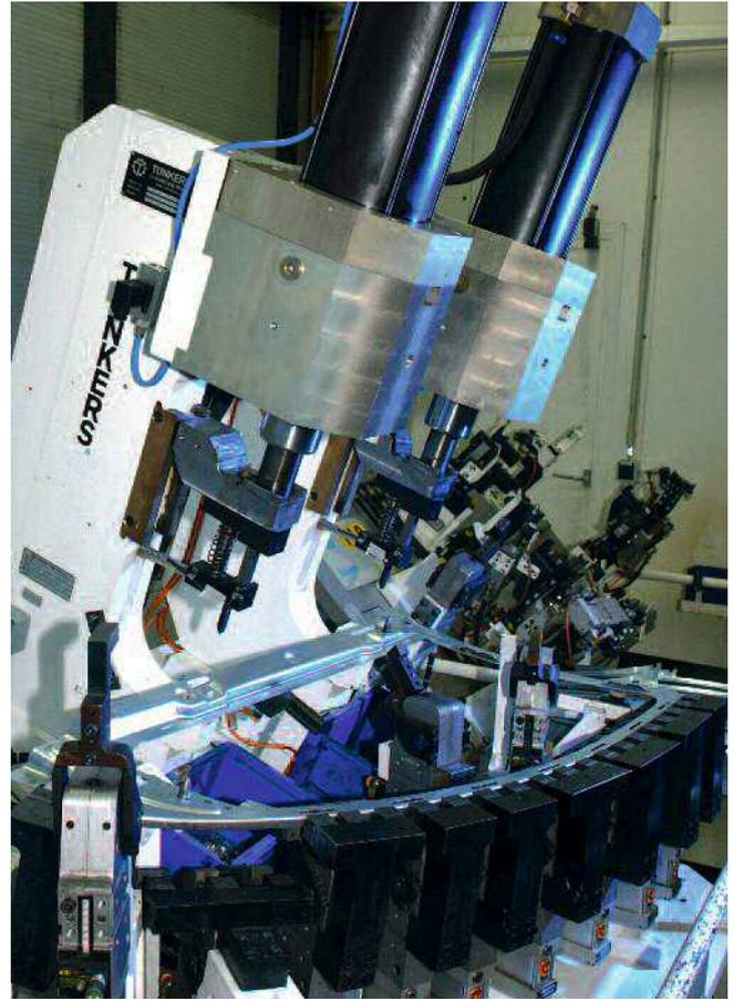
Vorrichtung zum Noppenprägen und Stanzmuttern setzen
