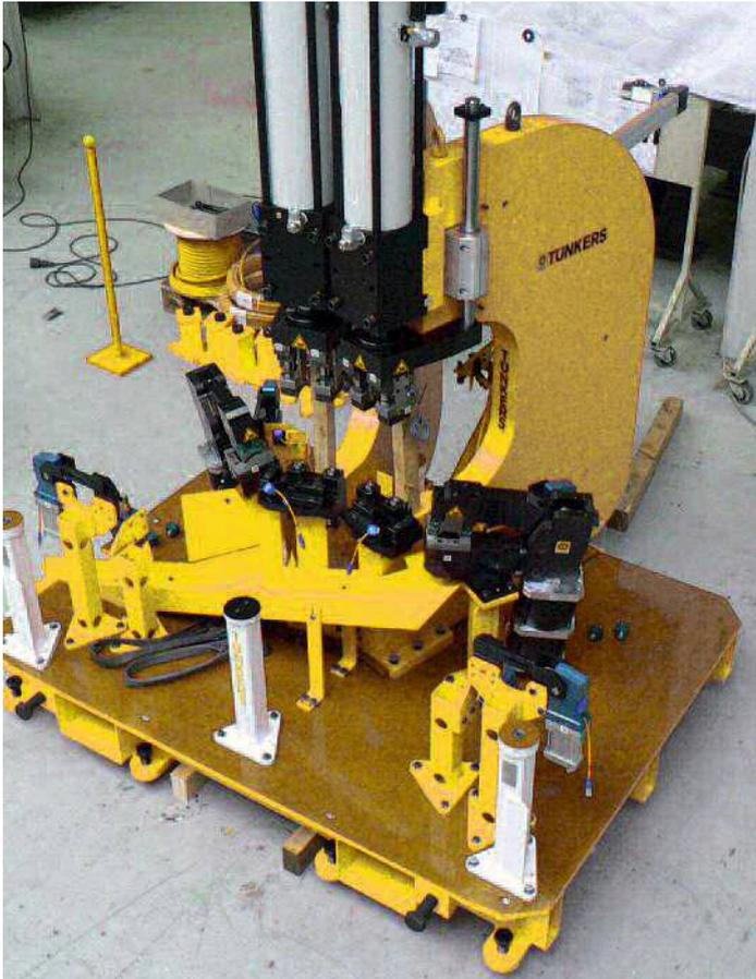
Vorrichtung zum Bolzensetzen und Beschneiden von Bauteil „Tür“
