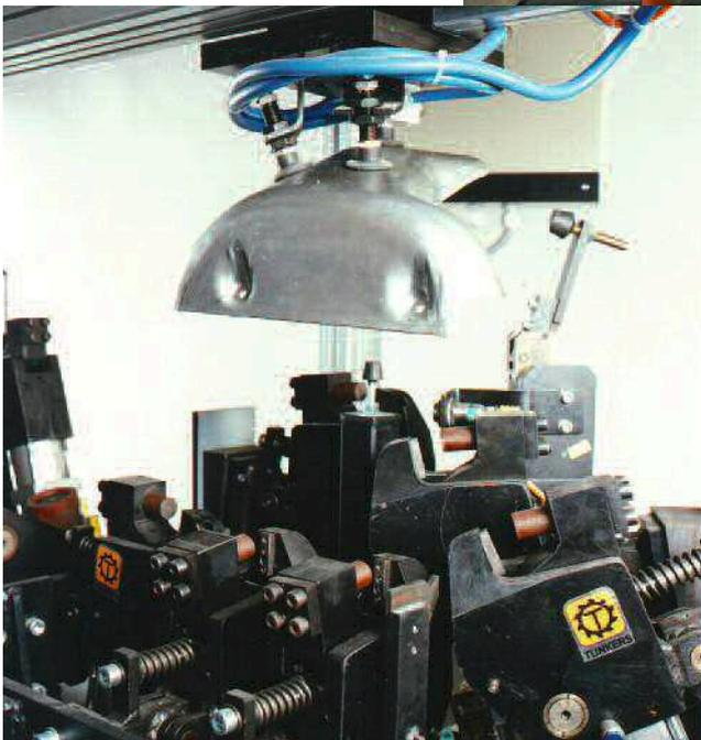
Vorrichtung zum Durchsetzfügen Abdeckblech-Auspuffkrümmer
