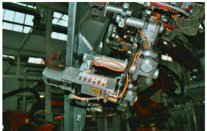
Alpha-Spanner an Robotergreifer
