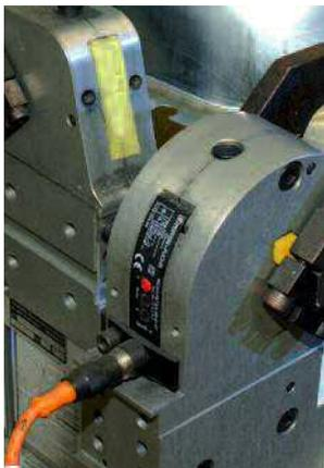
Abfragekassette montiert auf Kniehebelspanner
