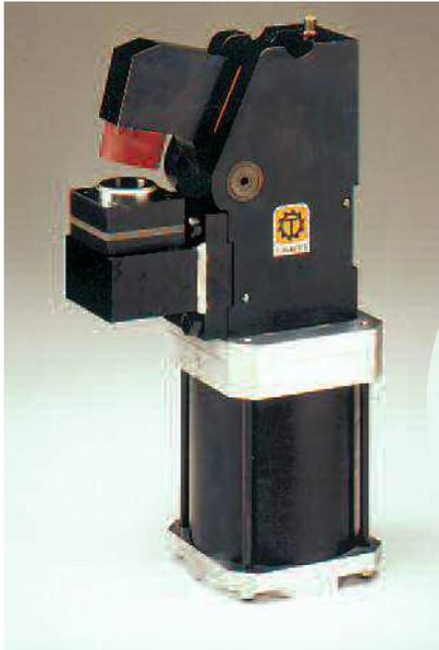
*Pneumatische Kniehebelzange zum Lochstanzen von Anschlussstutzen Ø 35 mm in Stahlblech*
