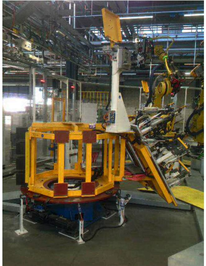
SOPAP TXE 1100 Werkzeugeinheit im Karosseriebau, flexible Drehvorrichtung für Werkzeuge
