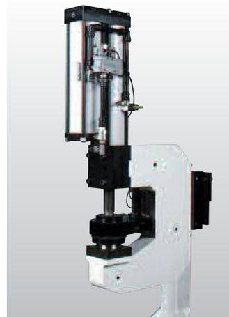
*C-Bügelsystem mit HydroAir Zylinder*
