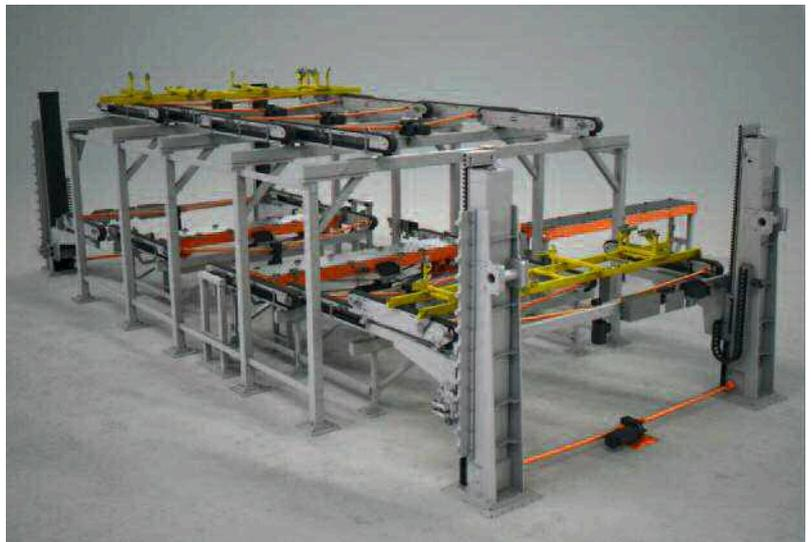
Hubvorrichtung für den Transport von kompletten Karossen von der Schweißebene in die übergeordnete, zweite Ebene der Fördertechnik.
