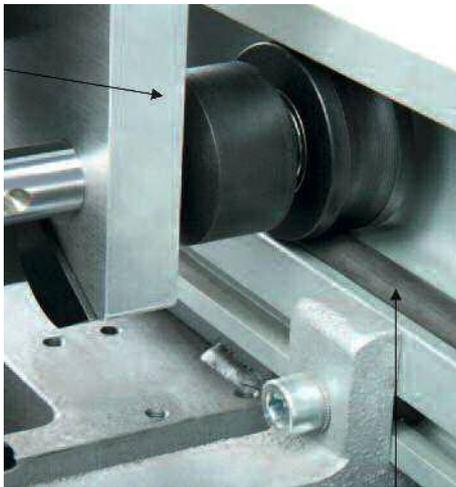
*Stahlrohr-Laufschiene im Profil eingelassen*
