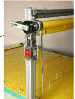
Pendelklappe mit Not-Stopp-Schalter bei Fehlbestückung
