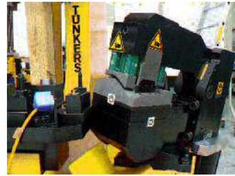
Kniehebelzange zum Beschneiden des Bauteils
