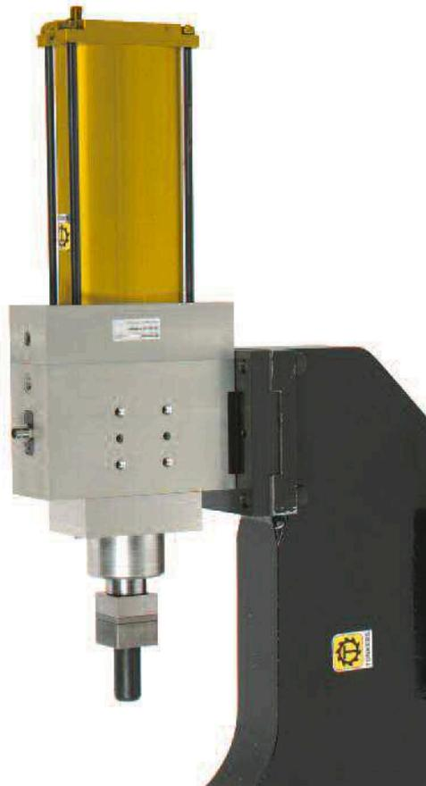
MZ 80 mit Kolbenstangenführung,
