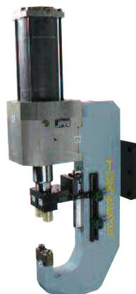
*C-Bügelssystem als Doppelstanze mit Multikraftzylinder*
