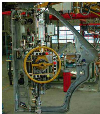
Manipulator-Greifer aus Rundrohrsystem (TRR)
